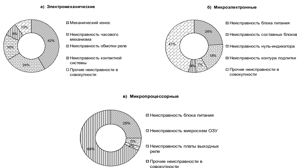
Рис. 8. Основные неисправности устройств релейной защиты и автоматики за 2017 и 2018 г.
