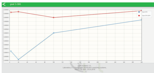
Рис. 1. Сравнение времени выполнения одной итерации CPU (крестики) и CPU-GPU(окружности) версий алгоритма. Малые размерности
