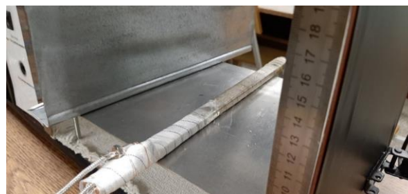
Рис. 6. Образец обмотки якоря тягового электродвигателя с размещенными термопарами Fig. 6. A sample of the winding of the armature of the traction motor with mixed thermocouples
