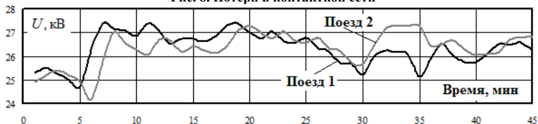
Рис. 9. Изменение напряжений на токоприемниках
