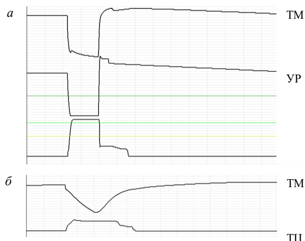
Рис. 1. Графики изменения давления в тормозной магистрали, уравнительном резервуаре и тормозных цилиндрах при экстренном торможении и отпуске в поезде длиной 364 оси при управлении с электровоза БКГ1:
