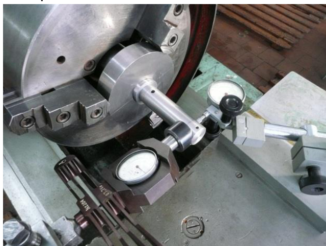
Рис. 3. Измерение упругих перемещений конического РК-3 профильного соединения на станке повышенной точности модели 16Б25ПСП
