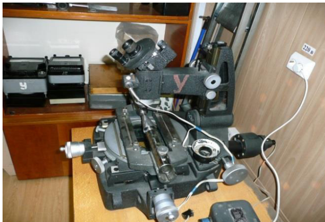
Рис. 2. Измерение угла уклона на большом инструментальном микроскопе БМИ-1
