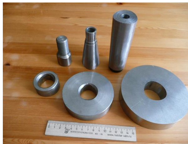
Рис. 1. Конструктивные виды РК-3 профильных деталей типа «вал» и «втулка» конических соединений
