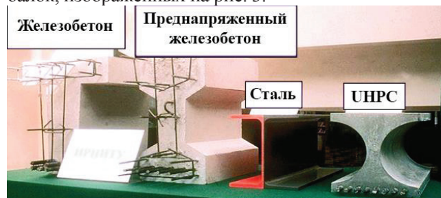
Рис. 3. Балки из различных материалов с равными показателями прочности
