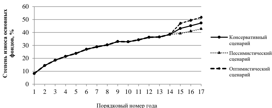
Рис. 4. Графическое изображение прогноза степени износа основных фондов железнодорожного транспорта России
