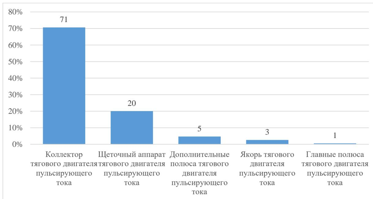
Рис. 2. Распределение отказов тяговых электродвигателей по узлам, %
