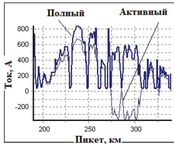
Рис. 2. Токвый профиль нечетного поезда (а) и четного поезда (б)
