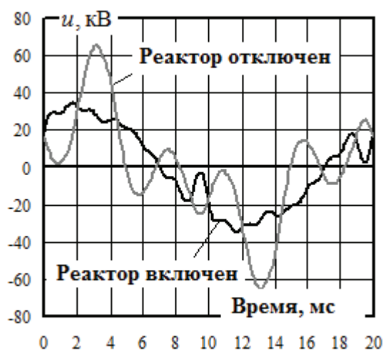
Рис. 8. Формы кривых тока и напряжения КБ1: а – напряжение; б – ток
