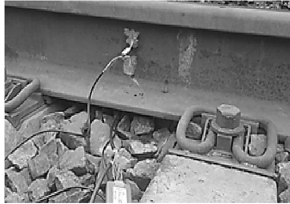
Рис. 1. Схема наклейки тензодатчиков в пути Fig. 1. The scheme of the sticking strain gauges during transit
