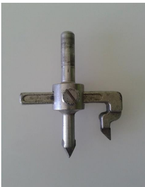
Рис. 1. Однозубая фреза в сборе
