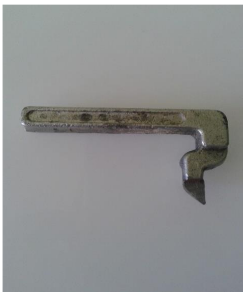
Рис. 2. Траверса однозубой фрезы с режущим лезвием
