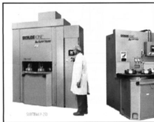
Рис. 3. Общий вид установки для удаления заусенцев термоимпульсным методом Fig. 3. General view of the device for deburring by thermal pulse method
