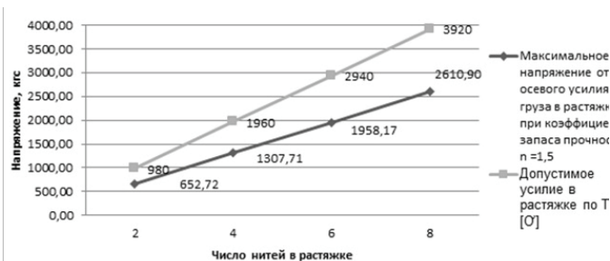
Рис. 7. Диаграмма изменения напряжения от количества нитей в растяжке при фиксированном коэффициенте запаса прочности
