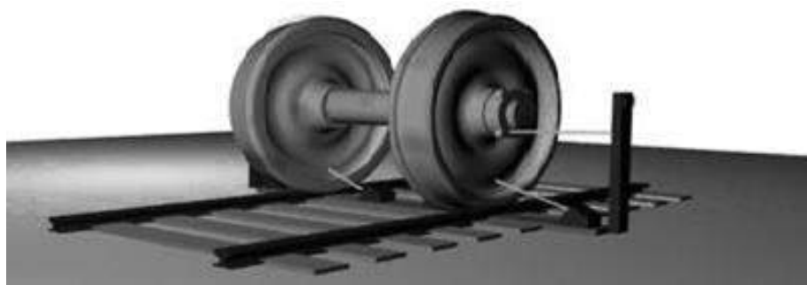
Рис. 4. Принцип автоматического сканирования колесных пар комплексом технических измерений
