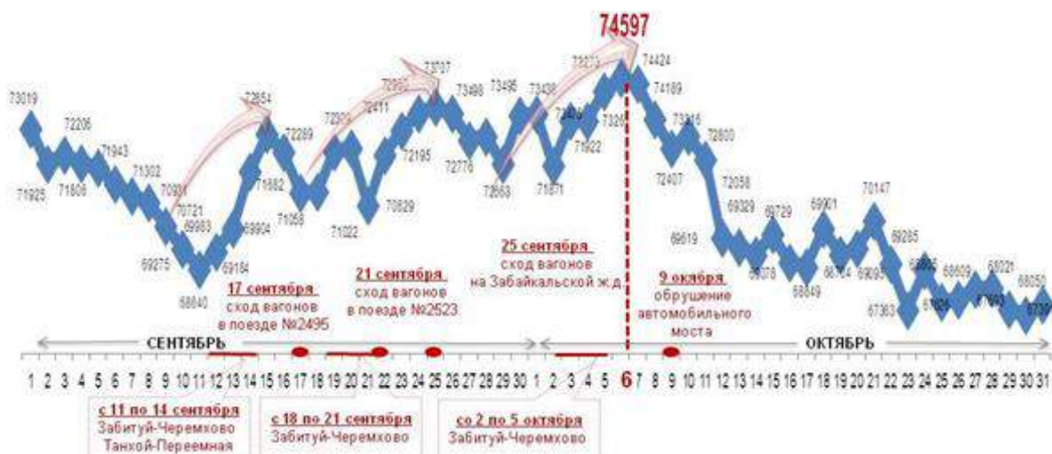
Рис. 2. Посуточная динамика изменения наличия вагонного парка в сентябре – октябре 2018 г. на Восточном полигоне
